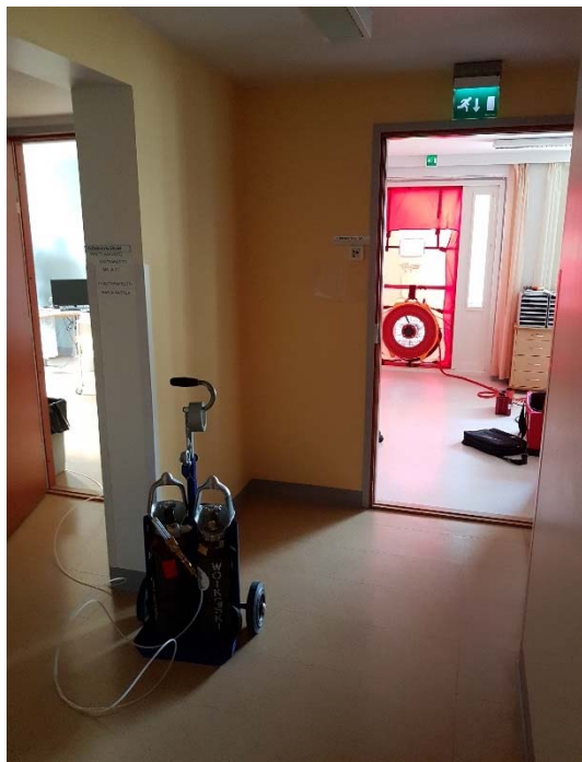
Kuva 38. Merkkiainetutkimuksia varten tilat alipaineistettiin oviaukkoon asennetulla säädettävällä puhaltimella.
