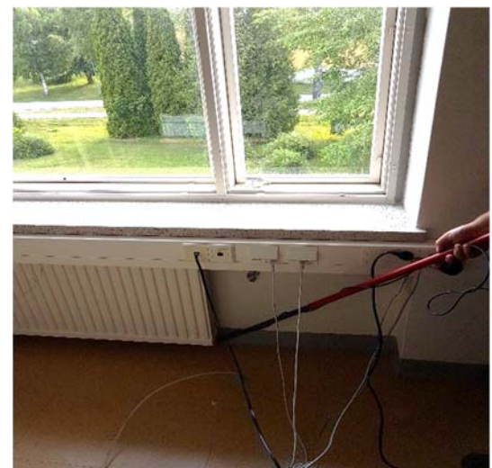
Kuva 31. Merkkiainetutkimuksin havaittu ilmapuotoireitti välipohjasta huoneessa 57.
