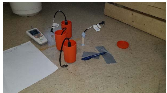
Kuva 14. Porareikämittauksin todettiin alapohjalaatan kosteudet eri syvyyksillä kosteuden kulkeutumissuunnan ja alkuperän määrittämiseksi.
