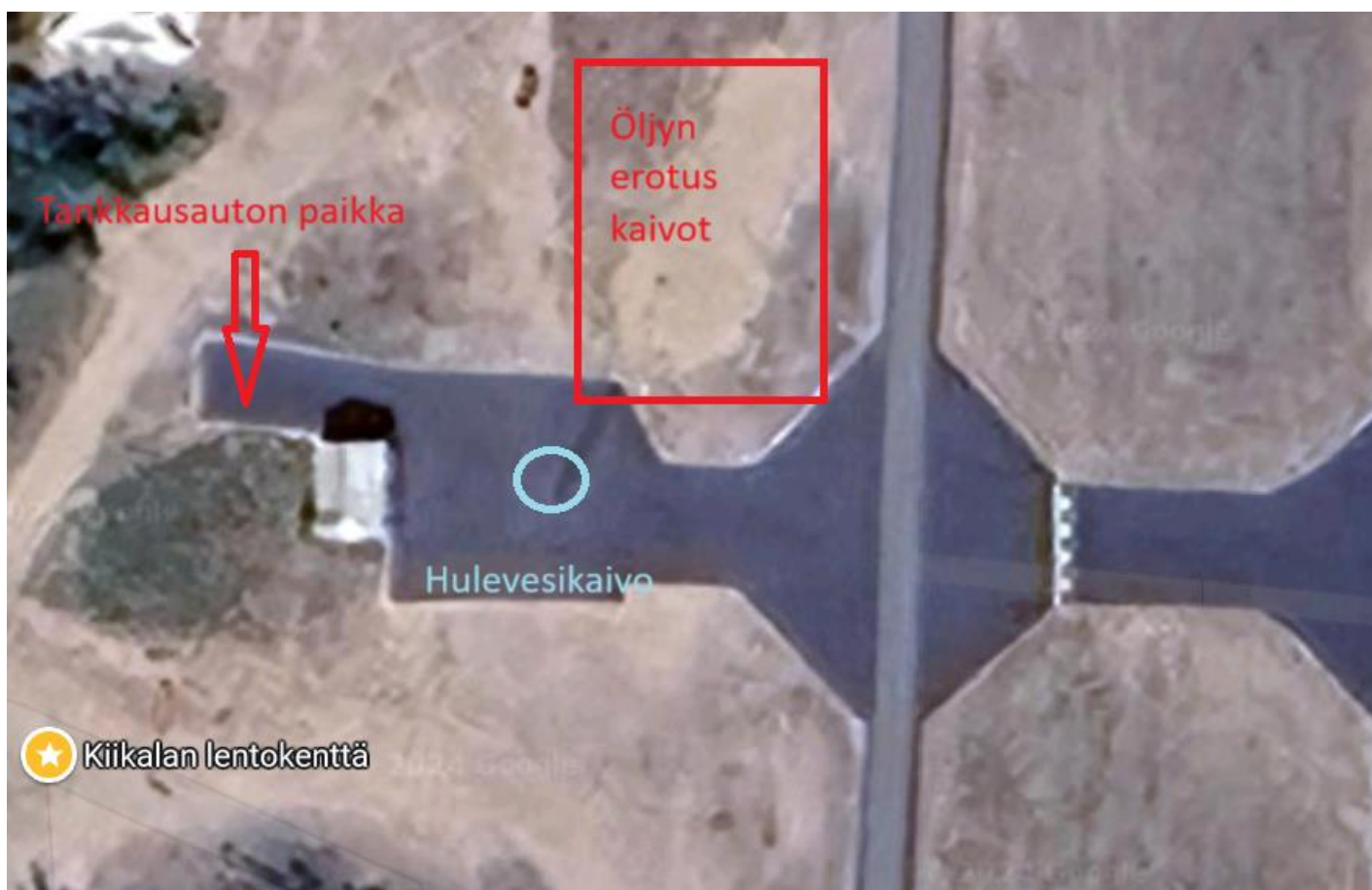
Kuva 10: Asfaltoinnit ja öljynerotusjärjestelmä
