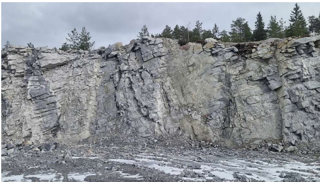
Kuva 2-1. Valokuva louhosrintauksesta (lounaasta koilliseen). Rintauksen korkeus on noin 12 m. Rintauksen alaosassa on vettä purkavia rakoja.
