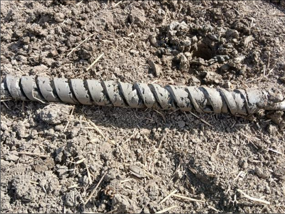
Kuva 7. Maanäyte yhden metrin syvyydestä
